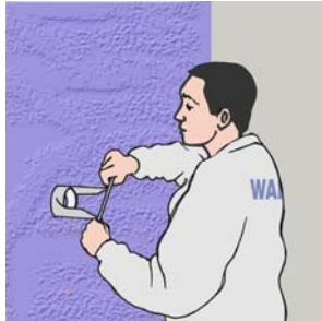
Figure 2 : Prélèvement d'une éprouvette par carottage
